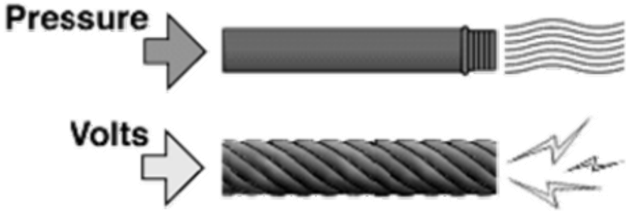
រូបទី ៣៥ : សំពាធ និងកំលាំងអគ្គិសនីចលករ [www.cipco.apogee.net]
